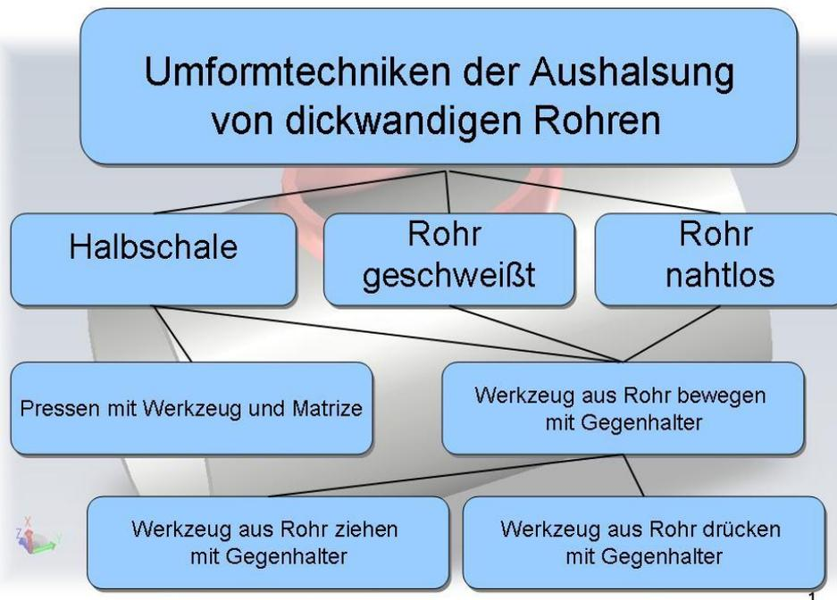
Die Warmumformung von geschweißten und nahtlosen Rohren mittels partieller Erwärmung wird durch viele Einflußgrößen beeinflusst. Die Werkzeugkonstruktion, Kräfteermittlung und Wärmeführung sind nur mit hohem experimentellen Aufwand zu bewältigen, daher wurde die numerische Simulation des Umformprozesses in der Abkühlphase angestrebt.
