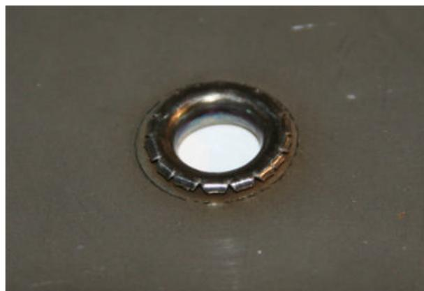
Bild 7 Stempelseite eines Fließhohl niertes aus 1. 4503
